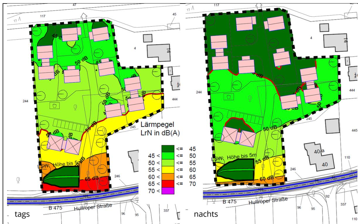
Abbildung 8: Lärmbelastung im 1. OG mit 5,0 m hohem Lärmschutzwall, ohne Maßstab (Quelle: RP Schalltechnik, Anlage 4)
